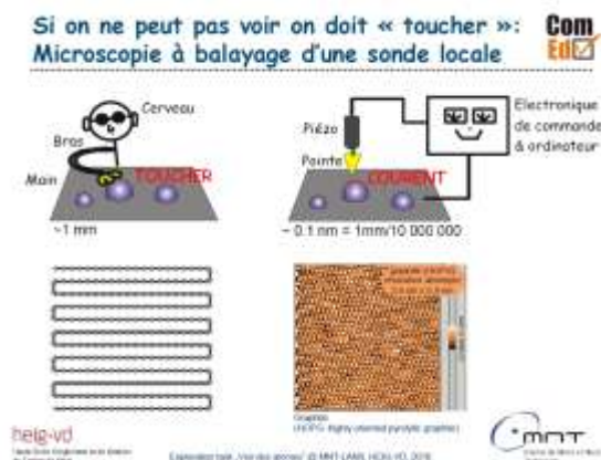
Figure 1: Exemple d'une illustration destinée aux apprenties pour l'explication du principe de fonctionnement des microscopes à balayage d'une sonde locale (ici microscope à effet tunnel).
